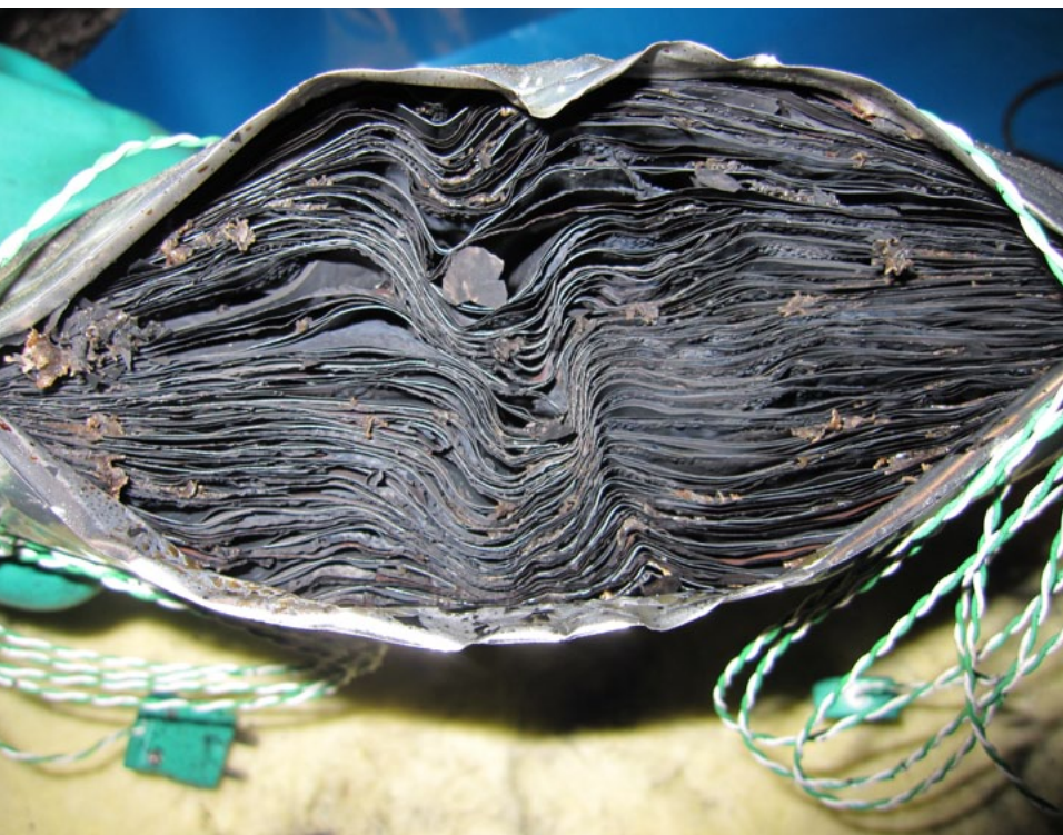
Eine geladene Lithium-Ionen-Batterie zelle nach einem Test, der ihre außerordentlich starke Detonation bewirkt.
